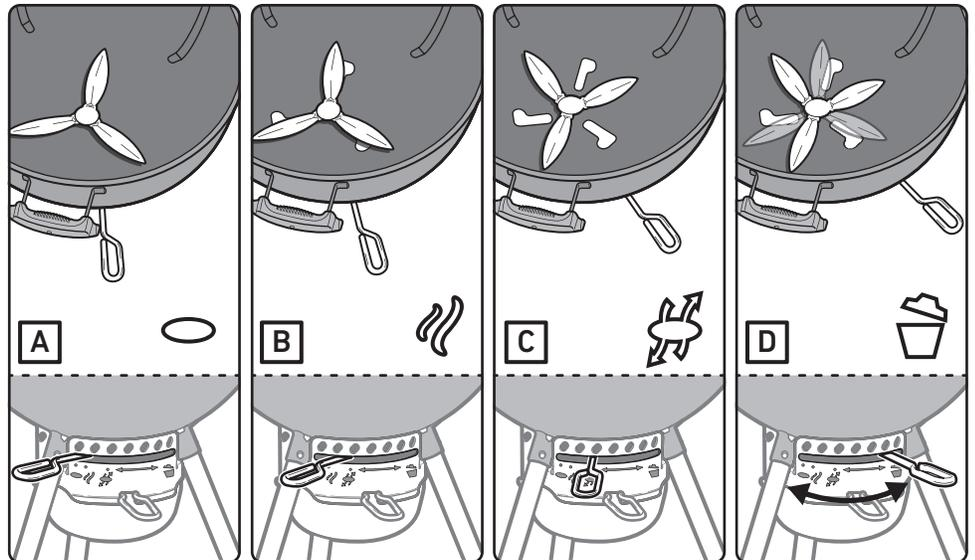
**DE** A – Lüftungsöffnungen geschlossen B – Räucherposition C – Lüftungsöffnungen geöffnet D – Asche entfernen
