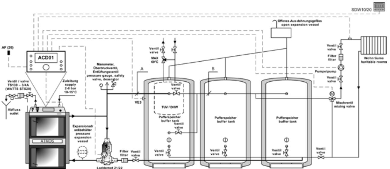
Der Kessel kann mit dem offenen oder geschlossenem Ausdehnungsgefäß angeschlossen werden.
