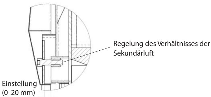
Die tatsächliche Einstellung ist durch einen Abgasanalysator an gegebene Bedingungen anzupassen. Unter Einstellung versteht sich das Herausziehen der Reglerzugstange.
