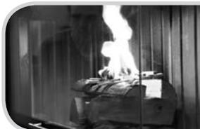
7. Das Anzündholz wird jetzt schnell entzündet und die oberen, dünneren Scheithölzer werden anfangen, hell zu brennen. Jetzt soll die Brennzellentür vollständig geschlossen sein.
