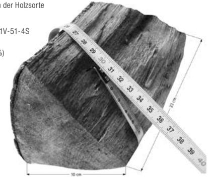
Wir empfehlen Ihre Brennzelle immer mit gespaltenem Scheitholz zu befeuern. Ein dreieckförmiges Scheitholz aus Buche wiegt bei einem Radius von 10 cm und einer Länge von 33 cm ungefähr 2,0 kg. Das umlaufende Kantenmaß sollte ca. 30 cm betragen. Die Holzaufgabemenge kann im Bereich ± 30 % variiert werden.
