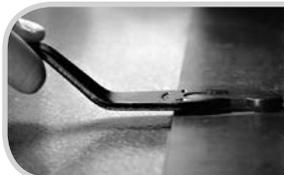
8a. Dazu wird der Stellhebel auf etwa Mittelstellung gedreht (Primärluft geschlossen). Wenn die Flammen jetzt sehr schwach werden, den Stellhebel wieder etwas weiter öffnen (nach rechts (+) drehen).
