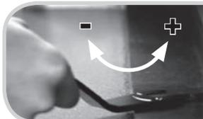
3. Die Verbrennungsluft vollständig öffnen. Drehen Sie den Stellhebel mit Hilfe der „Kalten Hand“ in die Anfeuerungsstellung ganz nach rechts (+).
