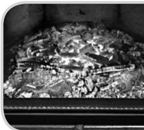
Das Abbrandende ist erreicht, wenn das Holz vollkommen abgebrannt ist, kein Schwelbrand oder eine unvollständige Verbrennung entstehen kann. Jetzt kann der Stellhebel geschlossen werden (linke Stellung).
