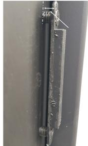
Um den Widerstand in der Tür zu ändern, werden die beiden Magnetmodule eingestellt.
