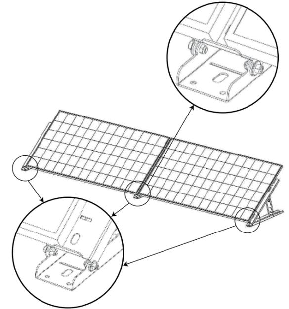
**Schritt 2.** Positionieren Sie die Solarmodule zwischen zwei Halterungen, wie auf der Abbildung dargestellt.
