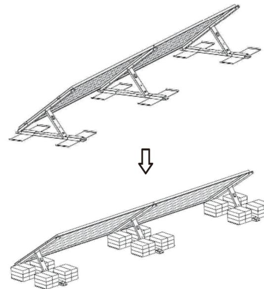
**Schritt 5.** Setzen Sie die Ballastplatte in die richtige Position und platzieren Sie schwere Gegenstände (z.B. Pflastersteine oder Gehwegplatten (nicht im Lieferumfang)) auf der Ballastplatte. Fertig.
