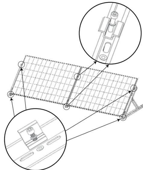
**Schritt 4.** Befestigen Sie die Zwischenklammern und die Endklammern an den Nietmuttern.
