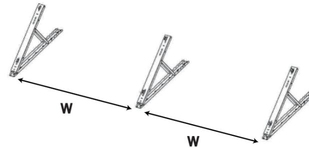
**Schritt 1.** Ordnen Sie die klappbaren Halterungen im gleichen Winkel in gleichmäßigen Abständen an.
