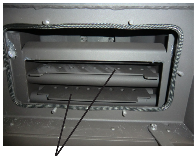
Fig. 6 Tôles de l'échangeur de chaleur
