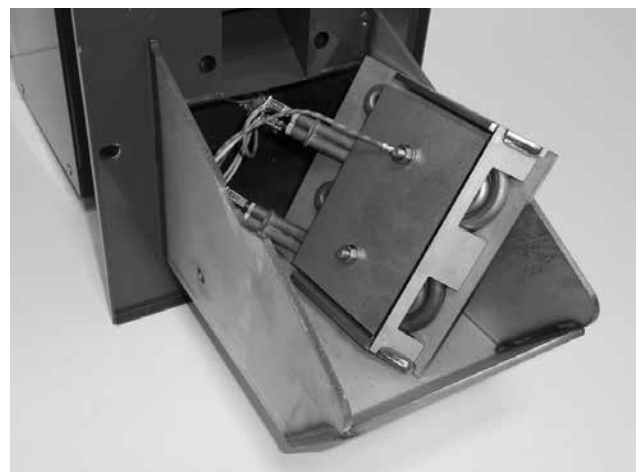
Abb. 4 - Demontierte Platte mit Glühspira- len
