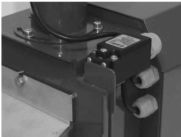
Abb. 8 – Endschalter mit Spezialanschlag
