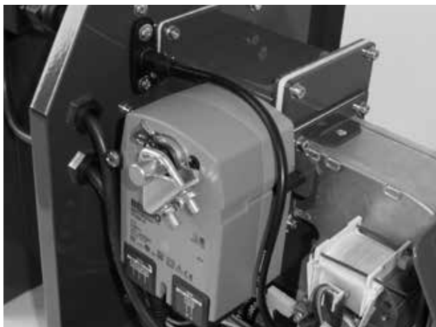
Abb. 11 - Sonderklappe mit Stellantrieb
