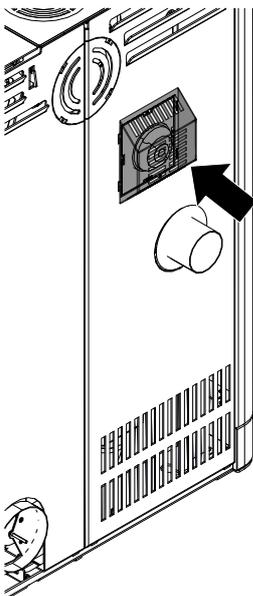
Abb. 43: Abdeckung auf Rückwand anbringen
