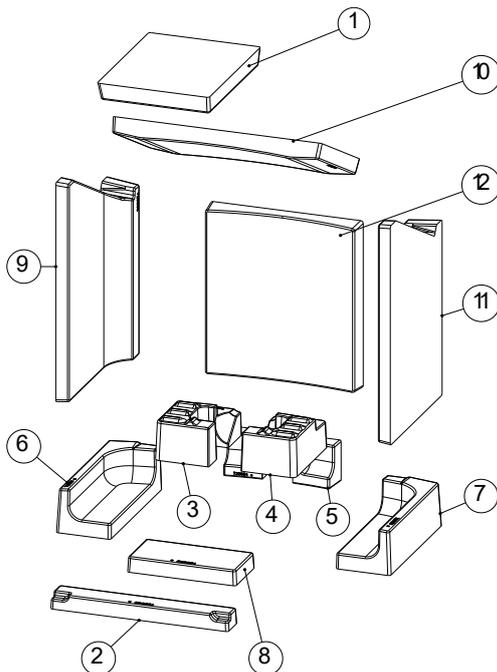
Abb. 23: Keramott montieren
