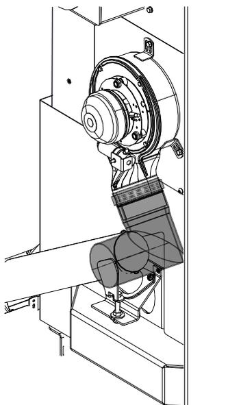
Abb. 40: Rohr raufstecken
