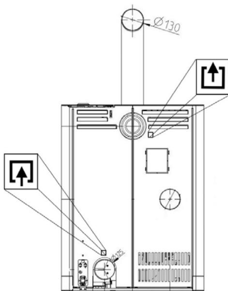
Abb. 50: Anschluss Verbrennungsluftzufuhr
