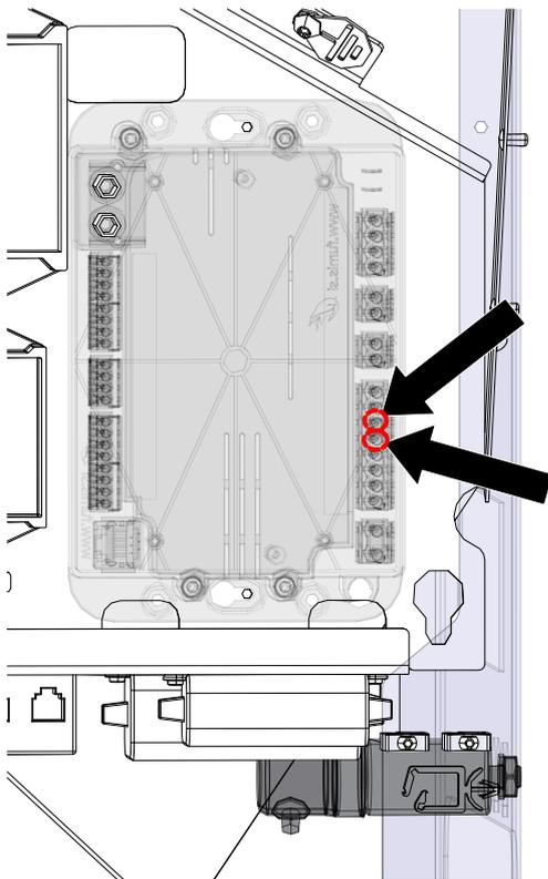
Abb. 38: Luftverteilermodul anstecken
