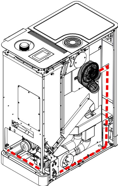
Abb. 36: Kabel verlegen
