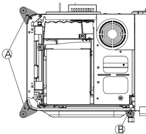
Abb. 15: Railingträger montieren
