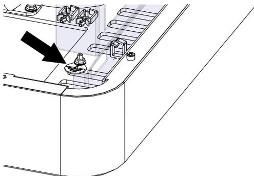
Abb. 39: Zentralerdung anschließen
