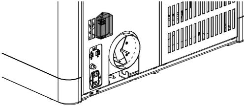
Abb. 122: WLAN-Box Abdeckung abnehmen
