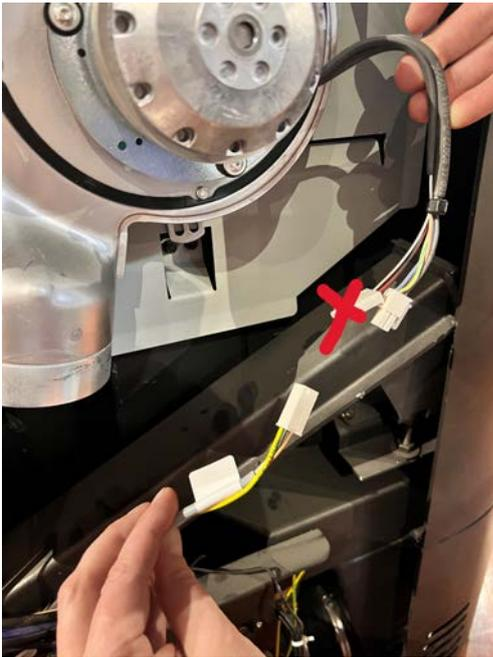
Abb. 35: Kabel verbinden
