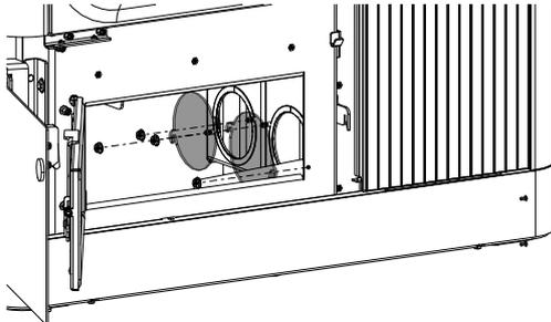
Abb. 115: Abdeckungen abmontieren
