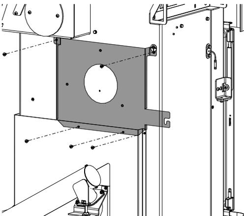
Abb. 45: Blech entfernen
