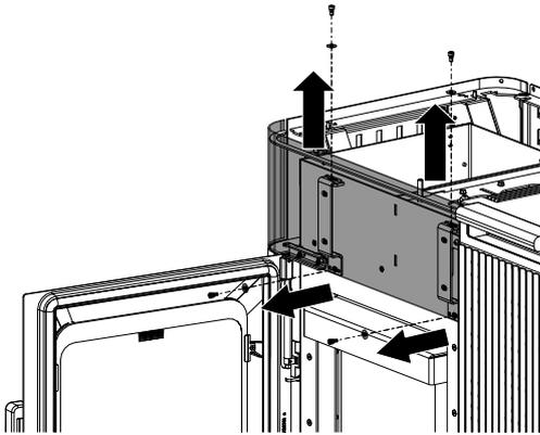
Abb. 12: Frontblende demontieren
