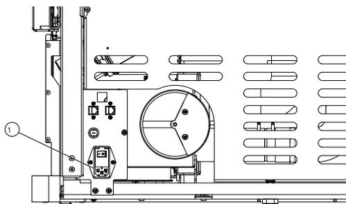
Abb. 51: Elektrischer Anschluss
