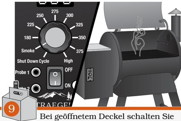
Bei geöffnetem Deckel schalten Sie den Schalter auf „ON“ (1) und den Temperaturregler auf „SMOKE“. Nach etwa 3-5 Minuten sind die Pellets entfacht und weiß-grauer Rauch kommt aus dem Grill. Nachdem die Pellets angezündet sind, schließen Sie den Deckel und stellen den Temperaturregler auf die gewünschte Temperatur.
