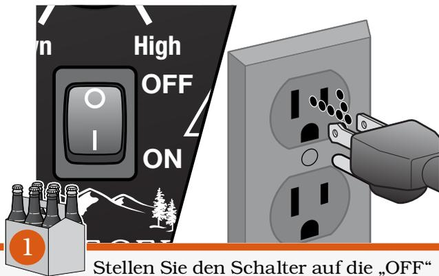
1 Stellen Sie den Schalter auf die „OFF“ (0) Position und trennen Sie den Grill von der Stromzufuhr. Der Grill muss vor der Entleerung vollständig auskühlen.
