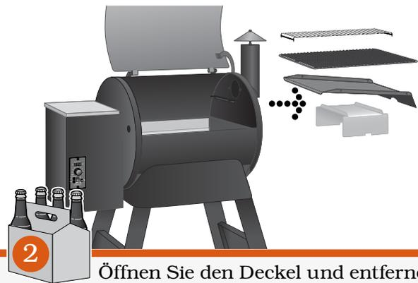
**2** Öffnen Sie den Deckel und entfernen Sie das Grillgut, die Porzellanbeschichteten Grillroste, die Fettauffangwanne und das Hitzeleitblech.
