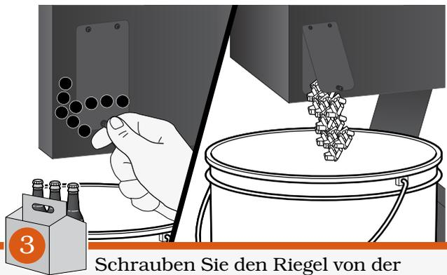
3 Schrauben Sie den Riegel von der Entleerungsklappe ab um diese zu öffnen, die Pellets werden in den Behälter unter der Klappe fallen. Mit einem Spatel oder einem Löffel können Sie restliche Pellets aus der Kammer entfernen.
