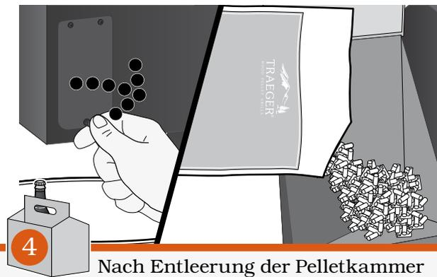
4 Nach Entleerung der Pelletkammer schließen Sie die Klappe und verschrauben den Riegel. Nun können Sie die Pelletkammer mit einer neuen Sorte Traeger Hartholzpellets befüllen.
