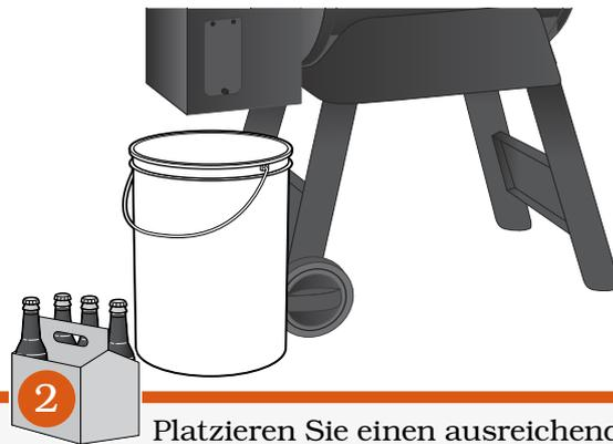
2 Platzieren Sie einen ausreichend großen Behälter unter der Pelletkammer-Entleerungsklappe.
