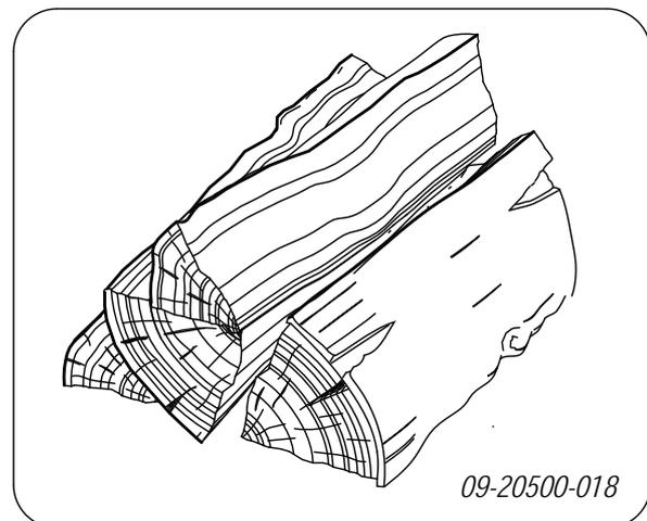
Bei einer kompakten Stapelung verbrennt das Holz langsamer, da der Sauerstoff zunächst nur einzelne Holzstücke erreichen kann. Stapeln Sie das Holz kompakt, wenn Sie länger heizen möchten.
