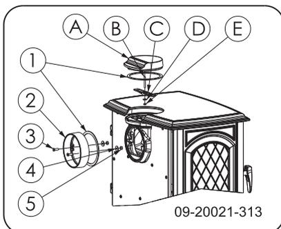
3. Montieren Sie das Anschlussstück (2) mit den Befestigungsmaterialien (3, 4, 5) an der Rückwand.
