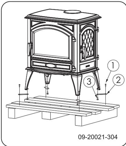
1. Nehmen Sie das Gerät von der Palette ab, indem Sie die Schrauben (1) entfernen.
