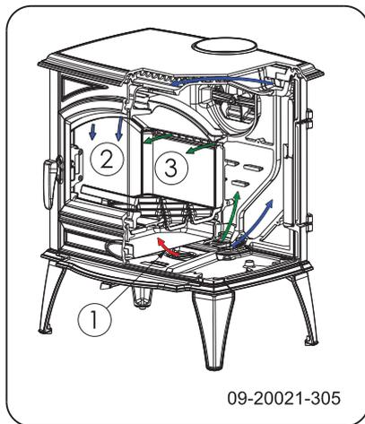
Das Gerät hat eine Luftklappe, die sowohl die primäre als auch die sekundäre Luft reguliert. Wenn sich die Luftklappe ganz links befindet, sind der primäre und der sekundäre Lufteinlass geöffnet. Je weiter die Luftklappe nach rechts geschoben wird, umso mehr schließt sich zunächst der primäre und dann der sekundäre Lufteinlass. Wenn sich die Luftklappe ganz auf der rechten Seite befindet, bleibt eine kleine Luftöffnung offen, um die Nachverbrennung unter der Flammpatte zu unterhalten.
