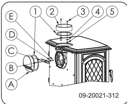
1. Entfernen Sie das Anschlussstück (2) von der Oberseite des Geräts.
