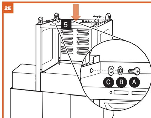
**HINWEIS:** Nachdem die Bodenplatte und die Rückwand angebracht sind, können Sie alle Schrauben an den Beinen festziehen (Schritt 2C).
