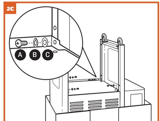
**HINWEIS:** Die Beine haben eine Clip-Vorrichtung, die an die entsprechenden Schlitz auf dem Grill angepasst ist. Ziehen Sie die Schrauben zu diesem Zeitpunkt noch nicht vollständig an.
