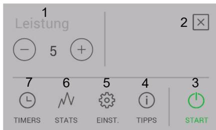
Abb. 14: Heizleistungsanzeige
