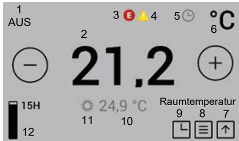
Abb. 13: Raumtemperaturanzeige, div. Funktionen
