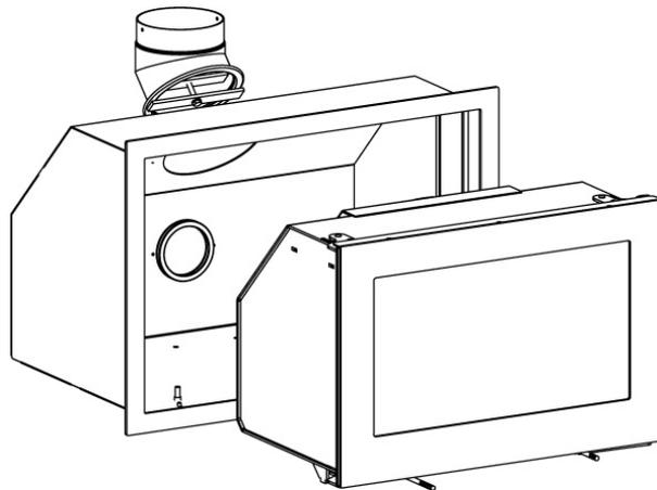
Die Kassette ist aus den Hacken bei den vorderen Füßen auszurasen und aus dem Gehäuse herauszunehmen. Das Knierohr IST an den Schornstein anzuschliessen.
