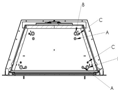
A: Löcher für die Befestigung der Einsatz im Verhältnis zur Unterlage.
