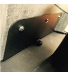
**7:** Placer stenen op mod metalpladen således at gevindhuller passer i de forberedte huller og spænd derefter stenen fast med en 10mm topnøgle.
