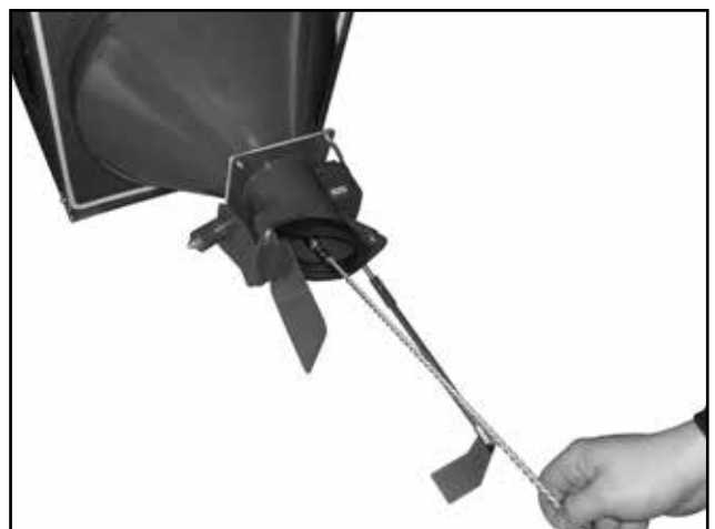
Bürsten des Siebs durch die Brennstoff-Ausschüttöffnung
