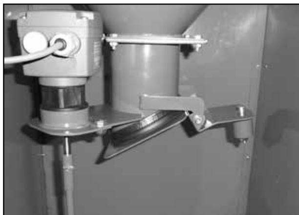
Klappe des Abscheidebehälters während der Befüllung – durch Unterdruck geschlossen
