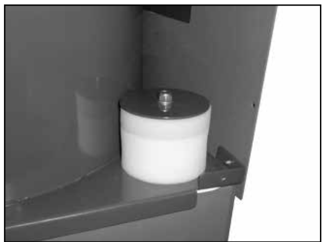
Schaumstofffilter auf den Austritt aus dem Pelletsvorratsbehälter
