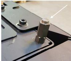
Die Topplatte wird passend mit den 4 Muttern unter der Topplatte, in der Höhe justiert.
