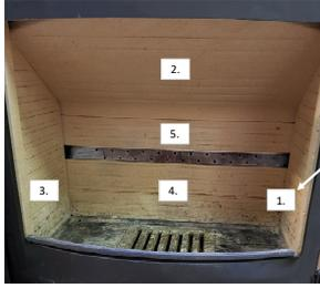
Zuerst Seitenplatte 1 entfernen, danach Platte 2, danach Platte 3, danach Platte 4 und zum Schluss Platte 5.
