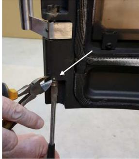
Den Stift entfernen und Den Zapfen anziehen (gegen Uhrzeigersinn) je nach Wunsch, wie kräftig die Federkraft im Griff sein soll.
