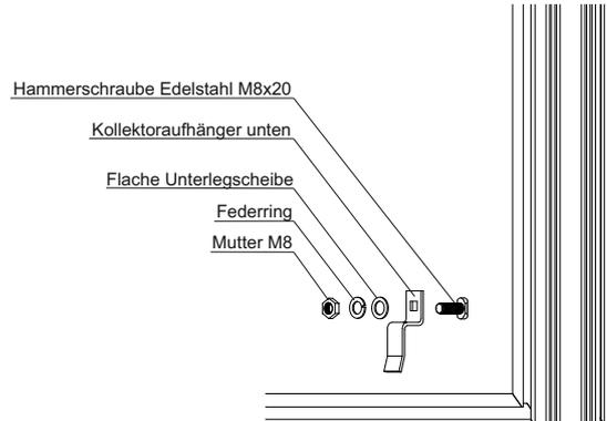
Die unteren Aufhänger mit Hammerschrauben M8x20 befestigen und fest anziehen.
