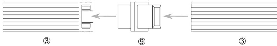
Den Verbindungsstift ⑨ in die horizontalen Balken ③ der Montagesätze einsetzen.
