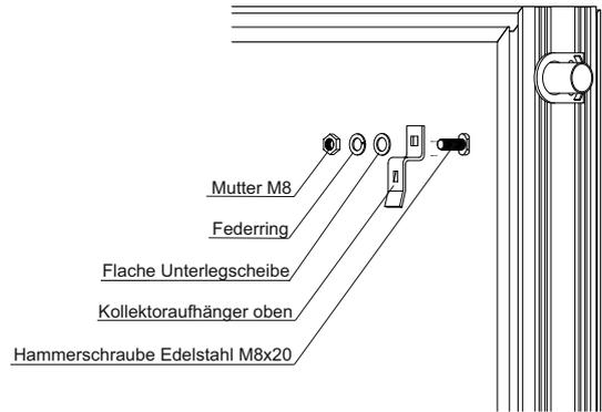
Den oberen Aufhänger mit Hammerschrauben M8x20 befestigen und leicht anziehen.
