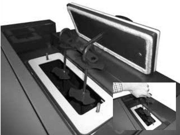
Beispiel des Herausnehmens der Bremsen aus dem Rohraustauscher (Rohrwand) vor der gründlichen Reinigung
