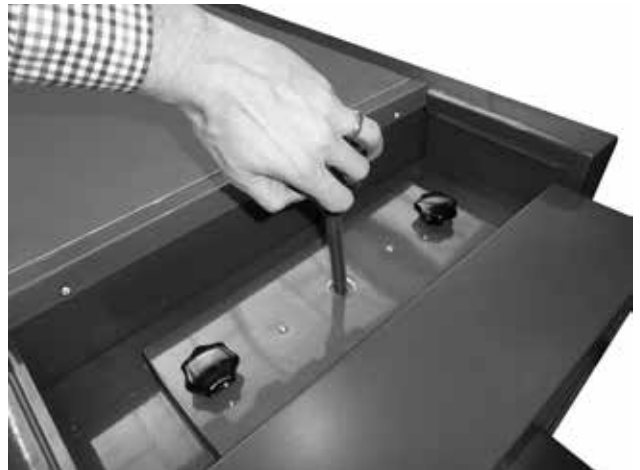
Beispiel der gewöhnlichen Reinigung des Rohraustauschers und der Bremsen durch kurze An-Auf-Bewegungen
