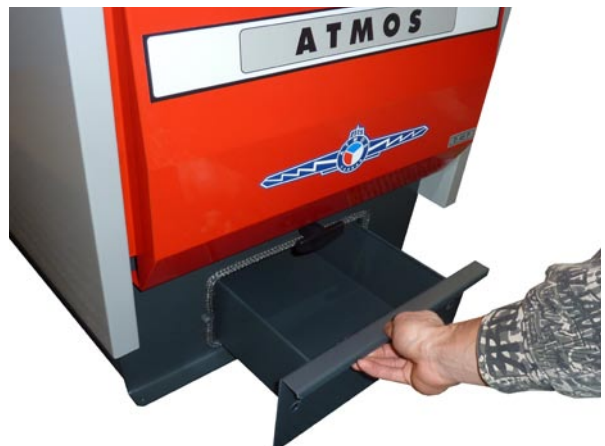
Herausziehen und Entleeren des Aschers
