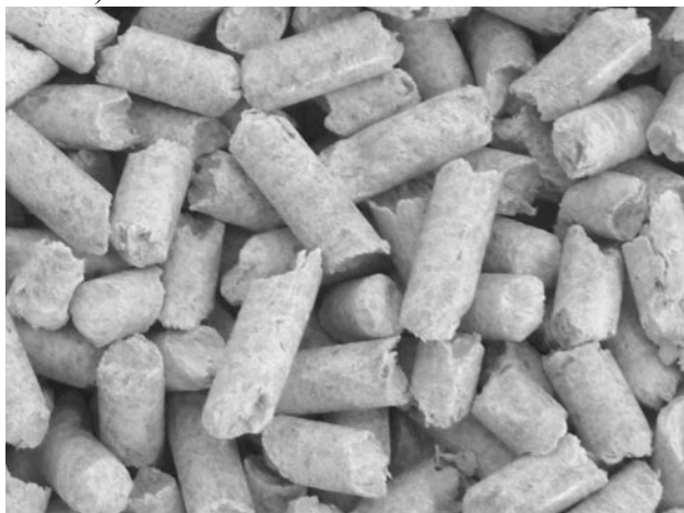
Hochwertige Holzpellets – Weißpellets ohne Schwarzpunkte (Rinde)
