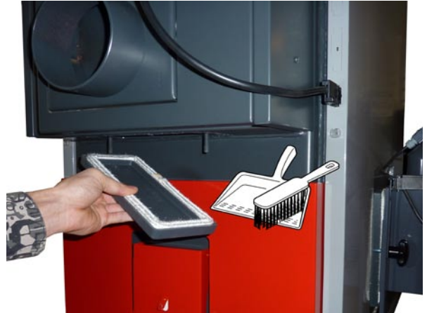
Veranschaulichung der Reinigung des Rauchabzuges im hinteren Bereich des Kessels.
