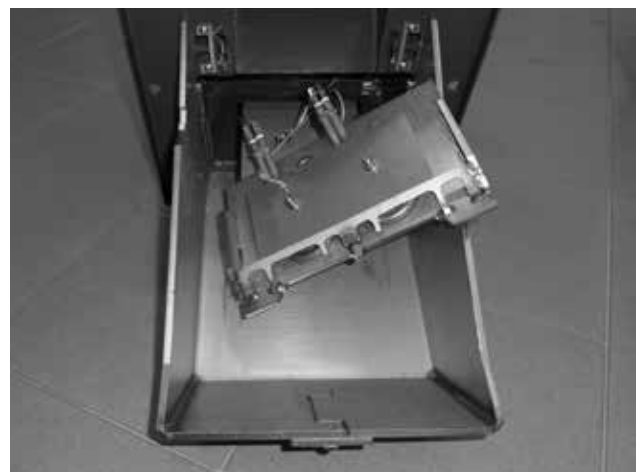
Abb. 4 - Demontierte Platte mit Glühspiralen
