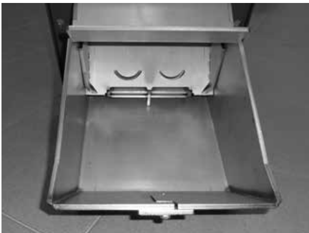
Abb. 3 - Verbrennungskammer mit einer Düse zur pneumatischen Reinigung und die Öffnungen, hinter denen 2 Zündspiralen angeordnet sind
