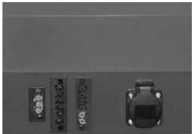
Abb. 12 - Brenner / zwei 6 Pin-Konnektore, -links Spannung, rechts Fühler, 3-PIN-Stecker für Anschluss des Drehzahlgebers des Kesselventilators und Steckdose für Förderschnecke
