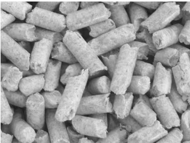
Abb. 17 – Hochwertige Holzpellets – Weißpellets ohne Schwarzkante (Rinde)
