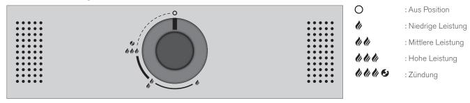
Der Brenner erreicht auf Stufe ( die höchste Leistung und auf Stufe ( die niedrigste Leistung.
