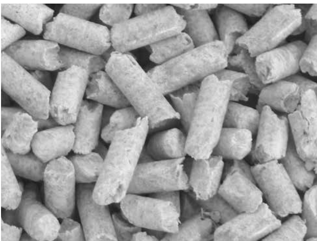
Abb. 17 – Hochwertige Holzpellets – Weißpellets ohne Schwarzpunkte (Rinde)
