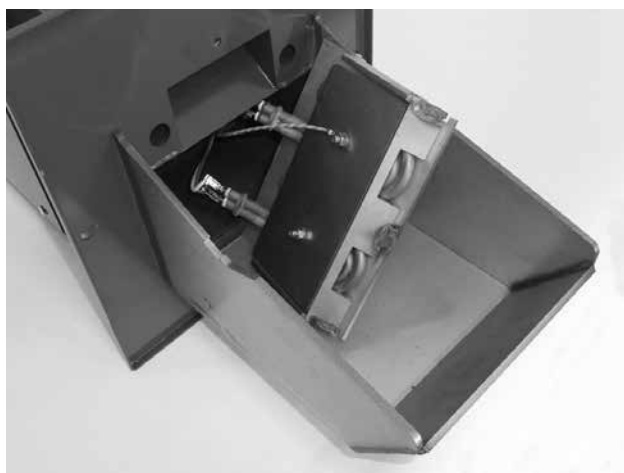
Abb. 4 - Demontierte Platte mit Glühspiralen
