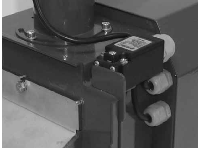
Abb. 8 – Endschalter mit Spezialanschlag
