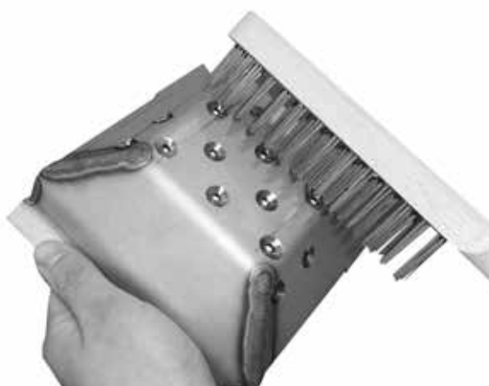
Beispiel: Reinigung der Brennkammer
