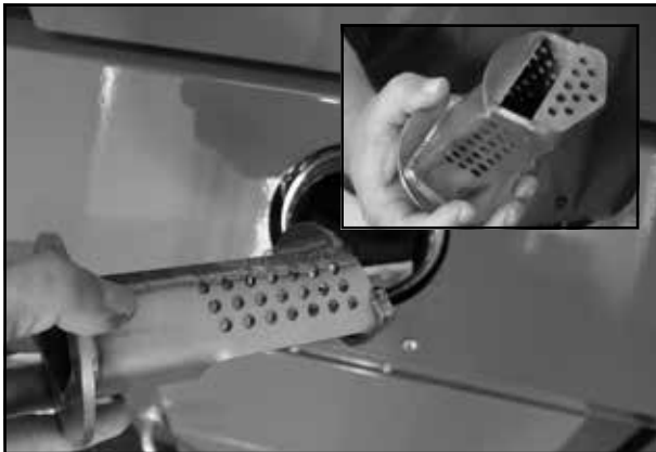
Die Zünd- und Blindkammer herausnehmen
