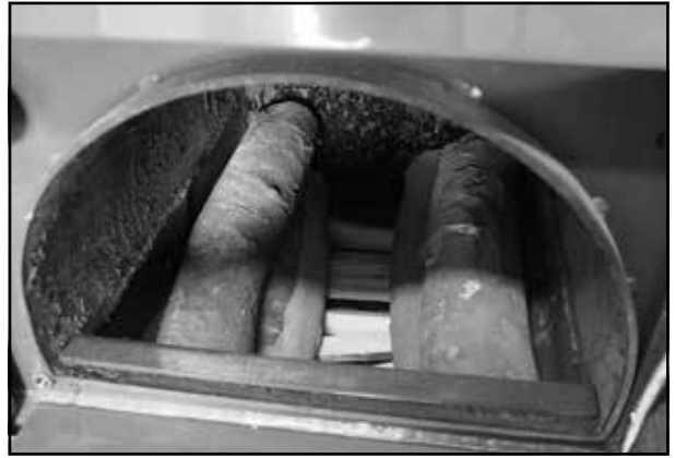
Vier größere Scheite auf beide Seiten der Nachlegekammer einlegen (2 + 2 Scheite)
