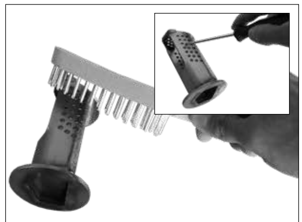
Die Reinigung des Zündkammer
