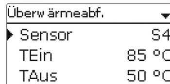
Diese Option dient dazu, überflüssige Wärme in den Heizkreis abzuführen, um die Systemtemperatur im Betriebsbereich zu halten. Wenn die Temperatur am zugewiesenen Sensor die Einschalttemperatur überschreitet, wird die Vorlaufsolltemperatur auf den eingestellten Wert geregelt. Wenn die Temperatur die Ausschalttemperatur unterschreitet, wird die Überwärmabfuhr inaktiv.
