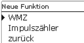
Im Menü **WMZ** können bis zu 7 interne Wärmemengenzähler und bis zu 3 Impulzzähler aktiviert und eingestellt werden.
