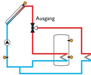
Diese Funktion dient dazu, im Falle starker Sonneneinstrahlung die entstehende überflüssige Wärme zu einem externen Wärmetauscher (z. B. Fan Coil) abzuführen, um die Kollektortemperatur im Betriebsbereich zu halten.
