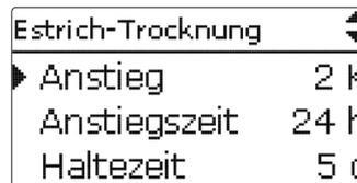
Wird die Vorlaufsolltemperatur nach den ersten 24 Stunden bzw. nach den jeweiligen Anstiegszeiten nicht erreicht oder wird sie dauerhaft überschritten, wird die Estrich-Trocknung abgebrochen. Der Heizkreis wird ausgeschaltet und eine Fehlermeldung angezeigt. Das Tastenkreuz leuchtet rot.
