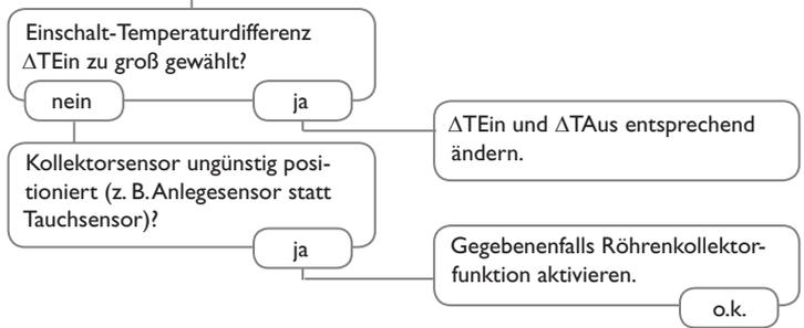
Pumpe läuft kurz an, schaltet ab, schaltet wieder an usw. („Reglerflattern“)
