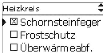
Die Schornsteinfegerfunktion ist in allen Heizkreisen werkseitig aktiviert. Der Schornsteinfegermodus kann aktiviert werden, indem Taste  $\odot$  für 5s gedrückt wird. Im Schornsteinfegermodus fährt der Heizkreismischer auf, die Heizkreispumpe und der Nachheizungskontakt werden aktiviert. Der aktive Schornsteinfegermodus wird durch ein rotes Blinken des Tastenkreuzes angezeigt. Zusätzlich wird im Display **Schornsteinfeger** eingeblendet und ein Countdown von 30 min heruntergezählt.
