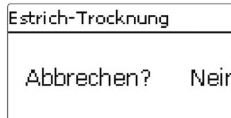
Zu Beginn der Estrich-Trocknung werden die ausgewählten Heizkreise mit der eingestellten Starttemperatur als Vorlaufsolltemperatur für die Anstiegszeit in Betrieb genommen. Danach wird die Vorlaufsolltemperatur jeweils für die Dauer der einstellbaren Anstiegszeit schrittweise um den einstellbaren Anstieg erhöht, bis die Haltezeit erreicht ist. Nach Ablauf der Haltezeit wird in umgekehrter Reihenfolge die Vorlaufsolltemperatur schrittweise reduziert, bis die Starttemperatur wieder erreicht ist.
