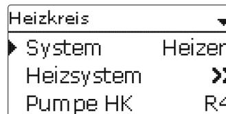
Wenn die gemessene Vorlauf­temperatur von der Vorlauf­sol­ltemperatur ab­weicht, wird der Mischer an­ge­steuert, um die Vorlauf­temperatur ent­sprechend an­zu­passen. Die Mischer­laufzeit kann mit dem Parameter **Intervall** ein­ge­stellt werden.
