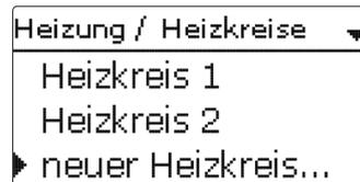
Werden ein oder mehrere externe Erweiterungsmodule angeschlossen, müssen sie im Regler angemeldet werden. Nur angemeldete Module erscheinen bei der Heizkreisauswahl. Wird **neuer Heizkreis...** erstmalig gewählt, wird der erste Heizkreis dem Regler zugewiesen.
