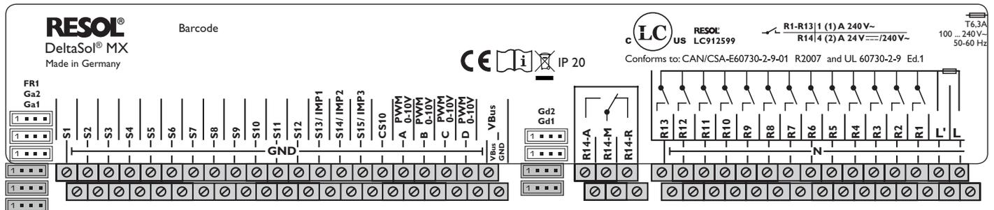
Die Volumenmessteile **V40** mit beliebiger Polung an die Klemmen S13/IMP1 bis S15/IMP3 und GND anschließen.
