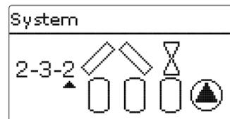
Hier verfügt jedes der Kollektorfelder über ein 2-Wege-Ventil, die Speicher werden über eine Pumpenlogik angesteuert.
