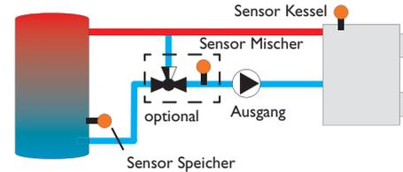
Diese Funktion dient dazu, Wärme aus einem Festbrennstoffkessel an einen Speicher zu übertragen.
