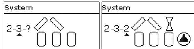
Der Regler unterstützt bis zu 3 Kollektorfelder und bis zu 5 Solarspeicher (bei 2 oder 3 Kollektorfeldern nur bis zu 4 Solarspeicher).
