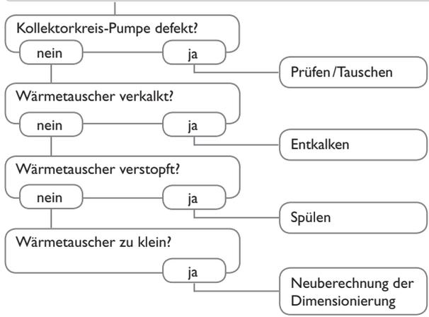
Die Solarkreispumpe läuft nicht, obwohl der Kollektor deutlich wärmer als der Speicher ist.
