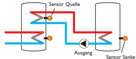
Diese Funktion dient dazu, Wärme von einer Wärmequelle an eine Wärmesenke zu übertragen.
