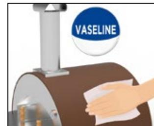
**5. Schutz des Edelstahls.** Für einen besseren Schutz der Edelstahlteile empfehlen wir die Verwendung von Vaseline (alternativ Oliven- oder Babyöl). Beim Aufstellen des Ofens am Meer, sollten Sie zur Vermeidung von Korrosion und Verkrustungen den Ofen häufig mit Süßwasser reinigen.
