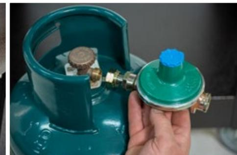
**2.** Schrauben Sie den Druckregler an das Gasflaschenventil und drehen Sie die Schraube von Hand gegen den Uhrzeigersinn. Verwenden Sie einen geeigneten Schraubenschlüssel für den Gasregler, um eine einwandfreie Anziehung zu gewährleisten, damit die Ventildichtung nicht beschädigt und die Gasdichtigkeit nicht beeinträchtigt wird.
