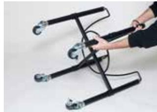
**A.** Zur Montage des Gestells das Basisgestell ohne Füße kopf über auf eine Unterlage stellen. Die Edelstahlkappen über die Gewindestangen setzen. Die Beine durch das Führungsrohr schieben und auf das Ende des Gestells schrauben. Um Kratzer zu vermeiden, empfehlen wir ein Blatt Papier zwischen Führungsrohr und Beine zu legen.
