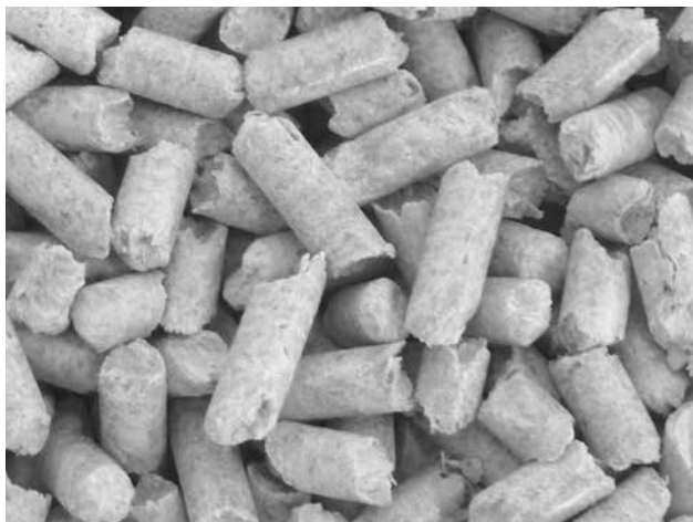
Hochwertige Holzpellets – weiße ohne schwarze Punkte (Rinde)
