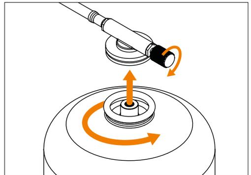
Überprüfe die Position des Anschlusses für die Schlauchleitung, um sicherzustellen, dass diese nicht verdreht wird.
