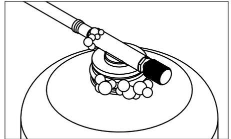
Sprühe die Verbindung zwischen Gaskartusche und Atago-Gasgrill, den Gaskartuschenhals und den Temperaturregler mit handelsüblichem Lecksucherspray ein oder pinsele diese mit Seifenwasser (Verhältnis 1 Teil Seife / 3 Teile Wasser) ein. Drehe den Temperaturregler gegen den Uhrzeigersinn, bis ein leises Zischen zu hören ist. Wenn keine Bläschen zu sehen sind, kannst du mit dem Grillen starten.
