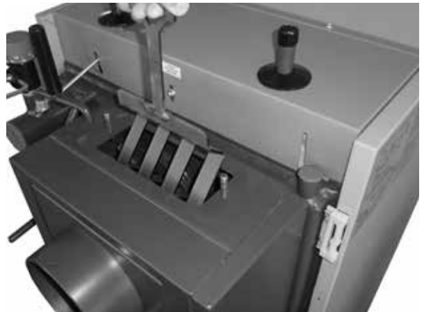
Ausziehen von Abgasbremser bei der Reinigung unter im hinteren Putzdeckel im hinterem Abgaskanal (außer KC16S)
