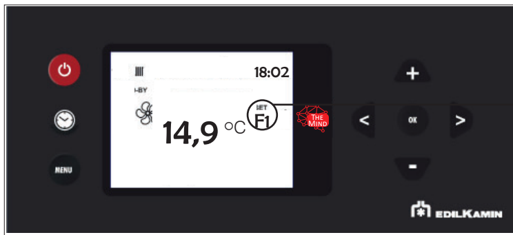
Anzeige der Nummer des Ventilators
