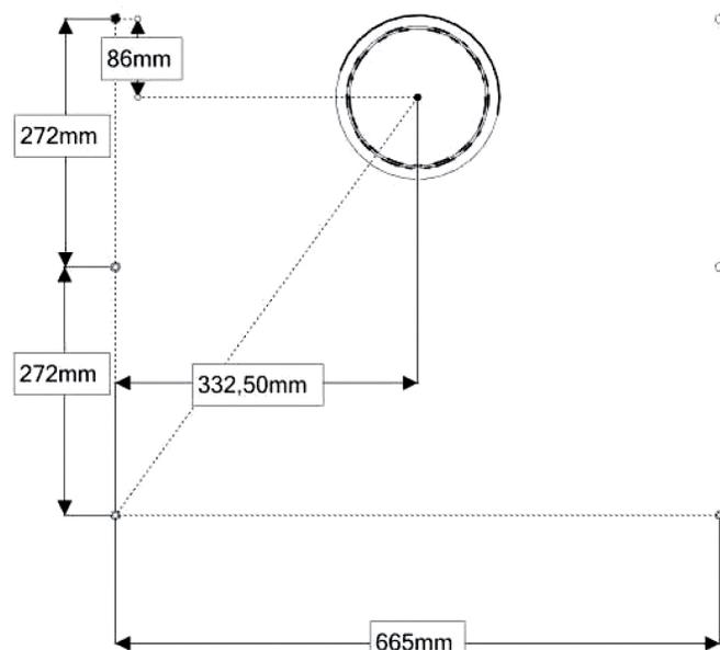
Im Lieferumfang des Wandmontagerahmens (12) befinden sich 6 Schrauben 8 mm und Dübel 12 mm zur Wandbefestigung.
